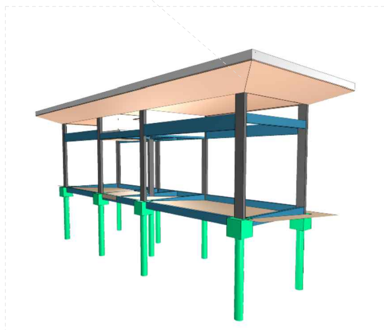
BEIRAL EM ESTRUTURA DE METALON APOIADO NA VIGA
